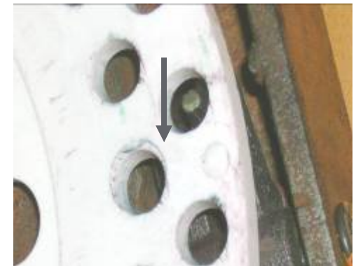
Regulación de gatillos expulsadores (50 % de espesor de placa)
